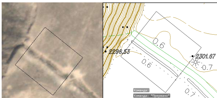
Рисунок 3.14 - Ортофотоплан (слева) и топографический план (справа) Участка 2.
