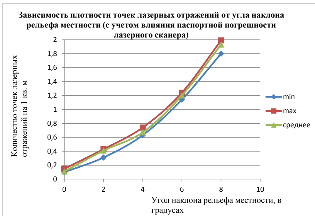
Рисунок 2.18 - График зависимости плотности точек лазерных отражений от угла наклона рельефа местности (с учетом влияния паспортной погрешности лазерного сканера)
