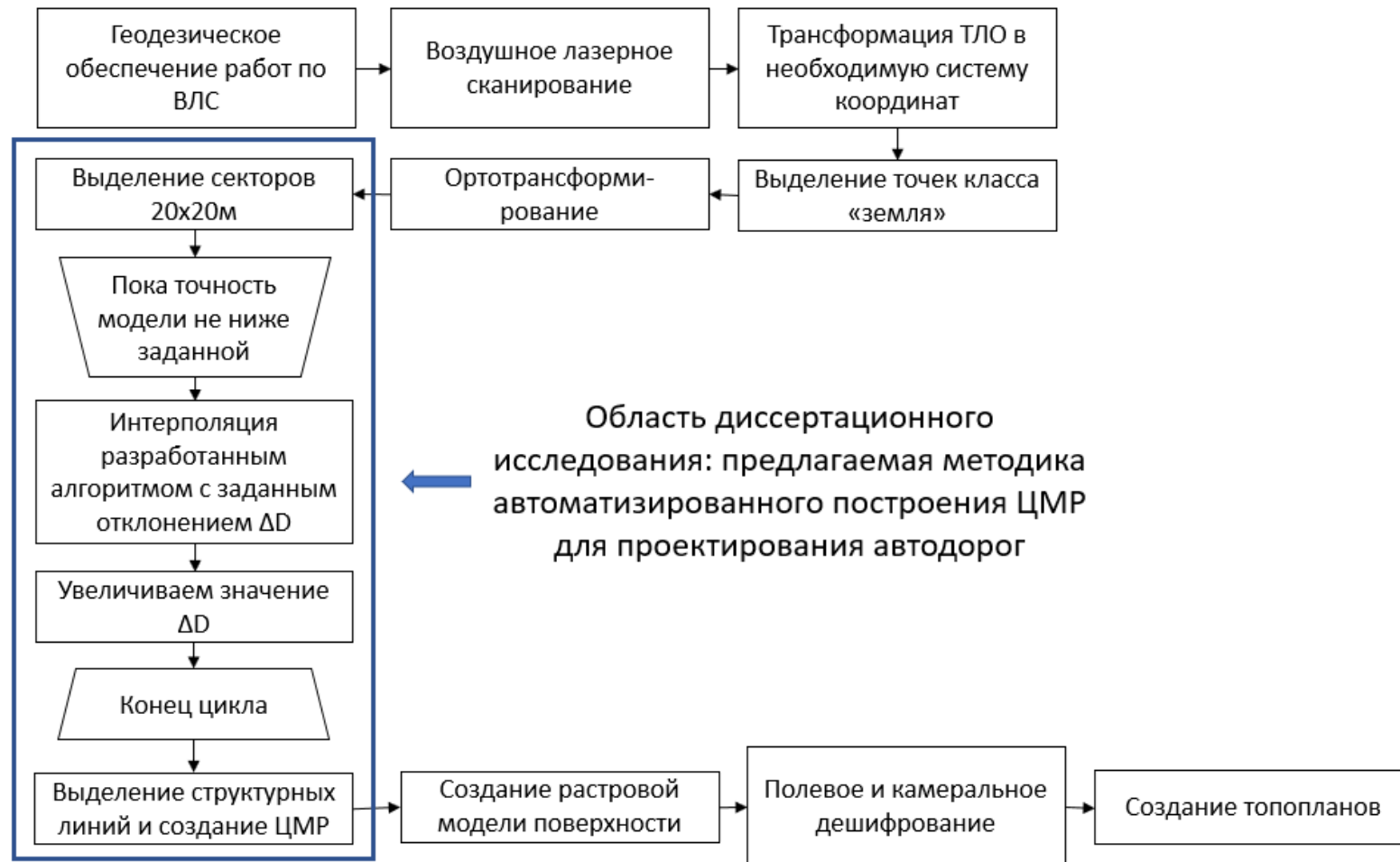
Рисунок 4.12 - Предлагаемая методика автоматизированного построения ЦМР для геодезических изысканий при проектировании автодорог
